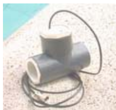
CAMARA DE IONIZACION
